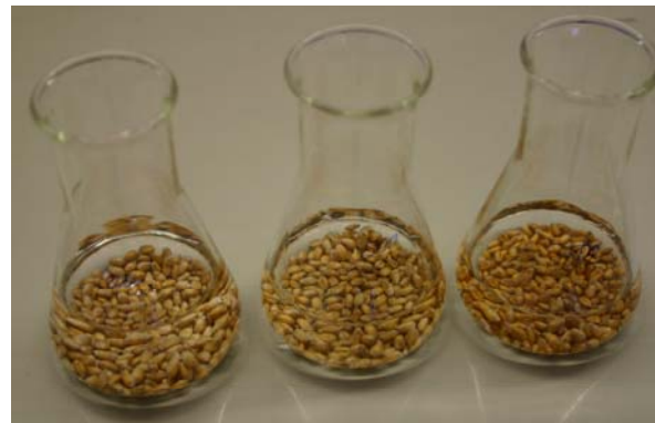
Zugabe von Flüssigkeit mit Detergenz zur Abtrennung der Sporen vom Korn
