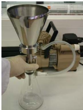
Trennung der Sporen und Separation auf Spezialfilter mit Zählquadraten
