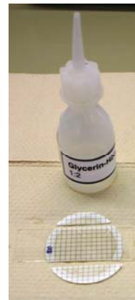
Vorbereitung des Spezialfilterpapiers für die Mikroskopie
