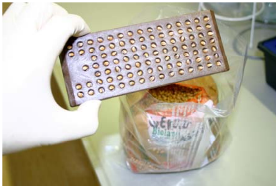
Entnahme der Analysemenge aus der Mischprobe des Landwirts
