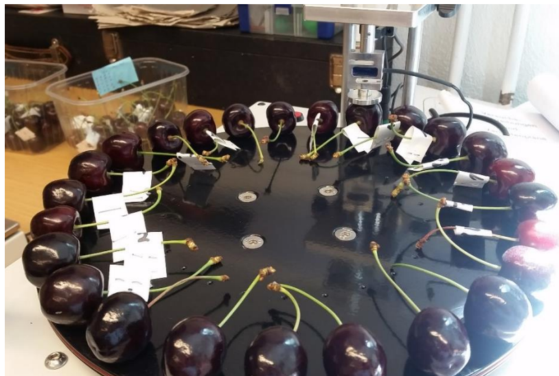
Abbildung 12: Firmtech-FT7 mit auf dem Drehteller aufgelegten Kirschen, während einer Messung. Im Bildhintergrund sitzt der Messstempel gerade auf einer Kirsche auf und erfasst Fruchtdurchmesser und Fruchtfestigkeit.
