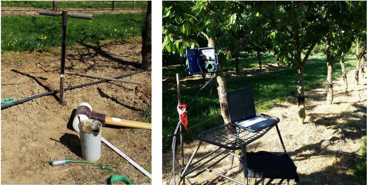
Abbildung 16: Links: Watermarksensor und die Materialien für den Einbau: Pürckhauer mit Hammer zum Lochschub, Metermaß zum Kontrollieren der Setztiefe und angerührter Boden im Messbecher, um den Watermarksensor im Boden einzuschlämmen. Rechts: Auslesen des Watermark-Datenloggers.
