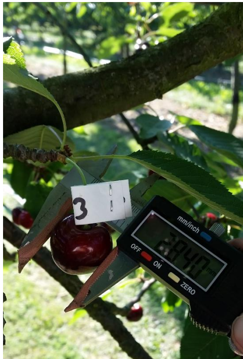
Abbildung 11: Digitaler Messschieber während der Fruchtwachstumsmessung mit abgeklebten Messschenkel zum Schutz der Kirsche.
