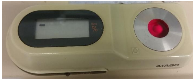
Abbildung 15: Digitales Refraktometer der Firma ATAGO während einer Messung eines Tropfen Kirschensaftes.
