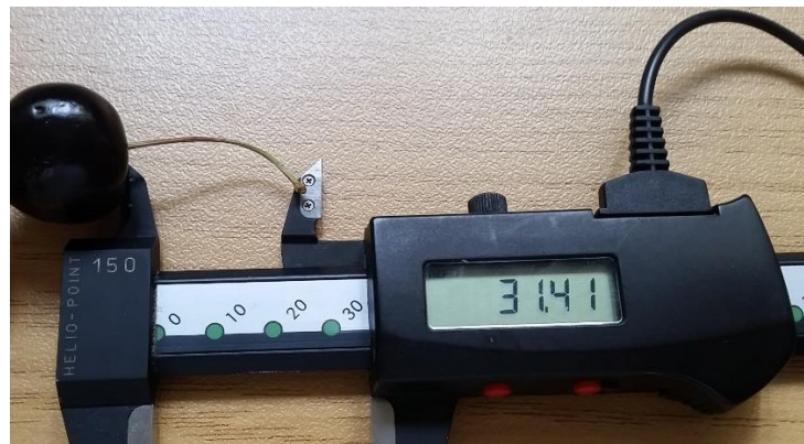
Abbildung 13: Digitaler Messschieber zur Erfassung der Stiellänge mit direkter Kabelverbindung zur Werteaufzeichnung am Computer.
