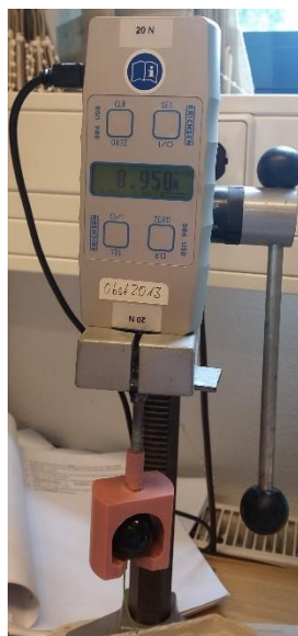
Abbildung 14: Erichsen-Kraftmesser mit eingehängter Kirsche. Im Bildschirm des Kraftmessers aufgezeichnet ist die maximale Kraft, bei der der Stiel von der Kirsche abreißt.
